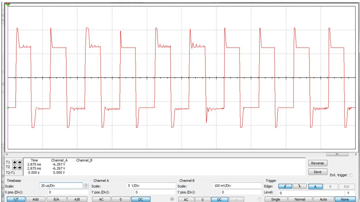
Slika 5.6 Valni oblik napona na trošilu (otpornik R1)
