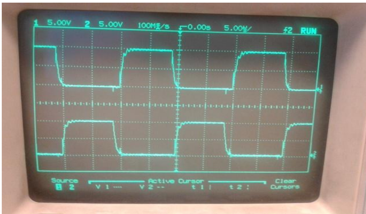
Slika 6.7 Valni oblik upravljačkog napona na upravljačkim elektrodama
