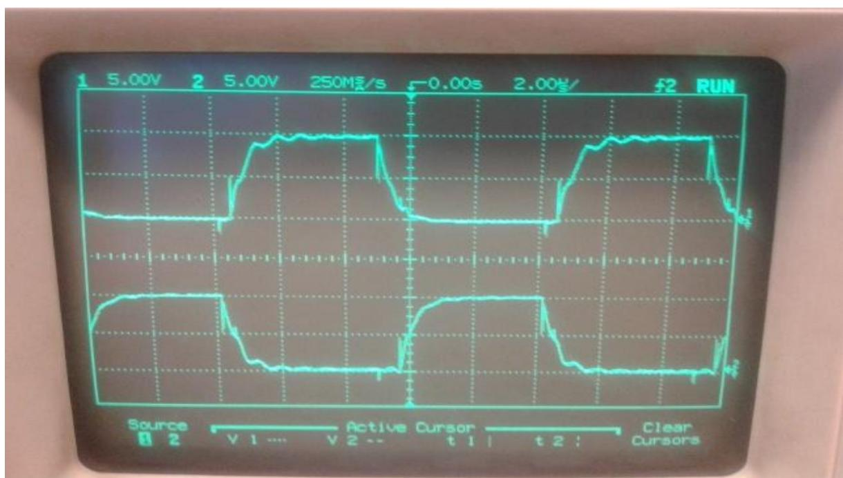
Slika 6.9 Valni oblik upravljačkog napona na upravljačkim elektrodam
