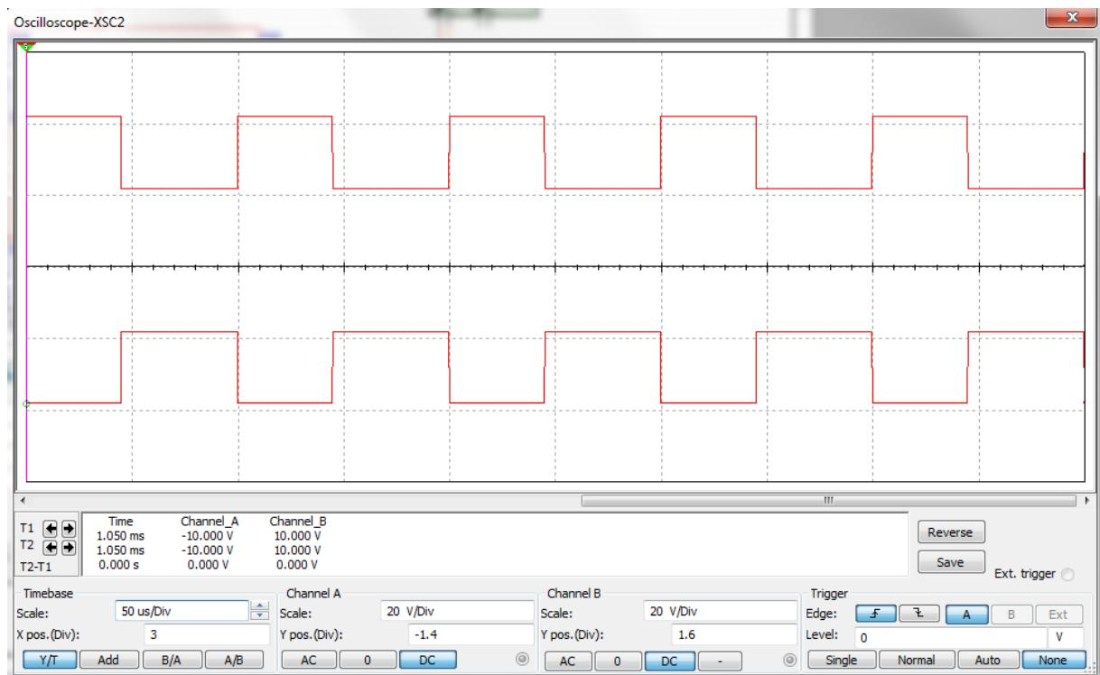
Slika 5.3 Valni oblik upravljačkog napona na upravljačkim elektroda
