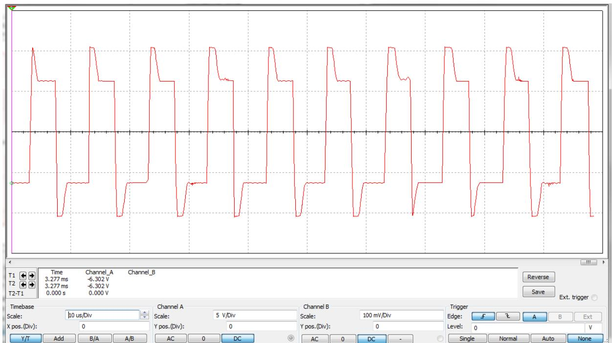
Slika 5.8 Valni oblik napona na trošilu (otpornik R1)
