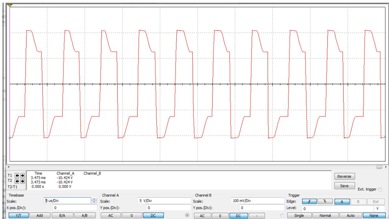
Slika 5.10 Valni oblik napona na trošilu (otpornik R1)
