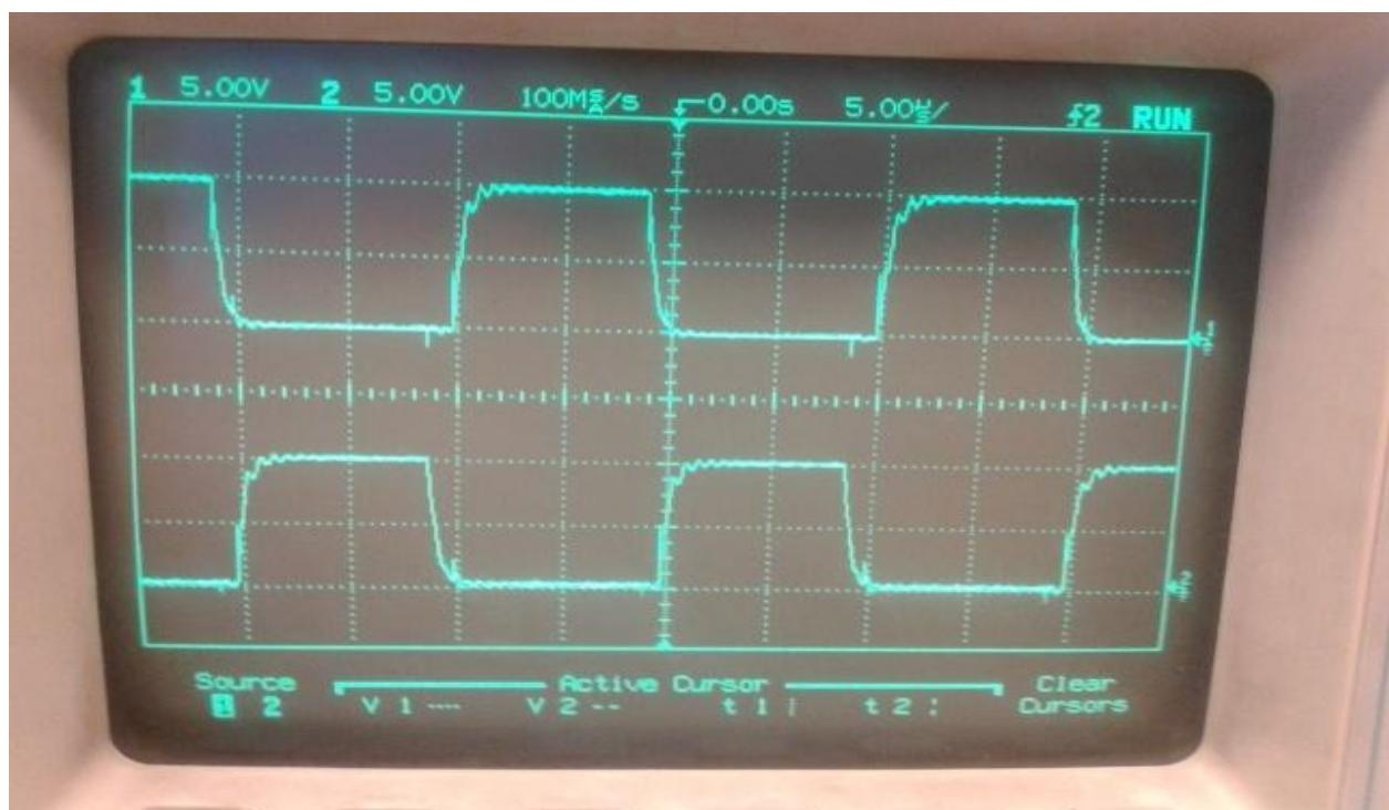
Slika 6.7 Valni oblik upravljačkog napona na upravljačkim elektrodamama
