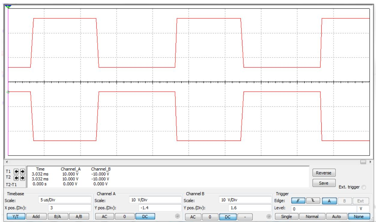
Slika 5.7 Valni oblik upravljačkog napona na upravljačkim elektrodamama
