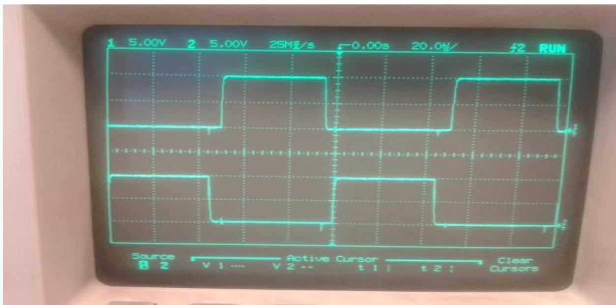
Slika 6.3 Valni oblik upravljačkog napona na upravljačkim elektrodamama
