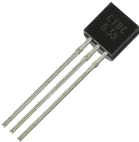
*Slika 4.2 Bipolarni tranzistor*
