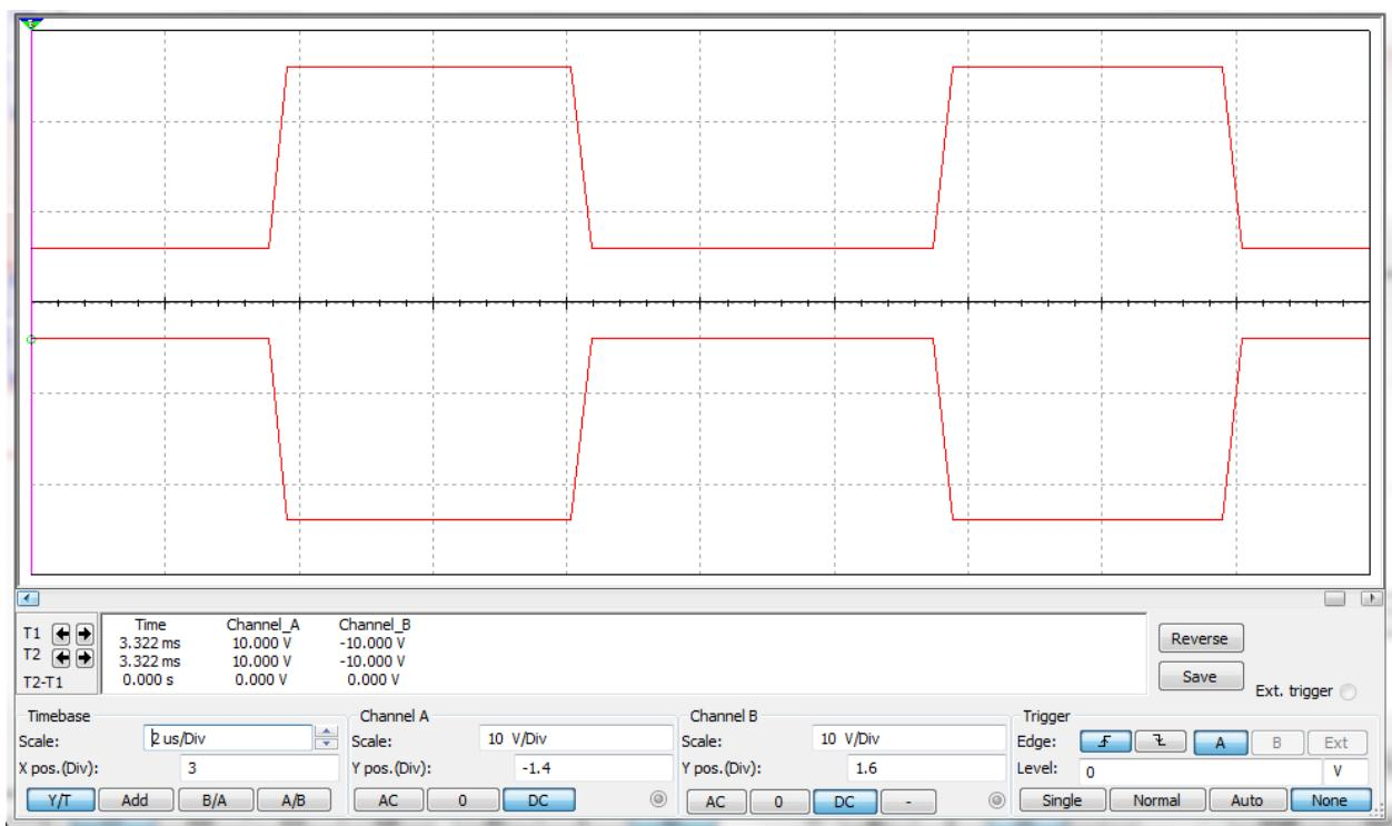
Slika 5.9 Valni oblik upravljačkog napona na upravljačkim elektrodamama
