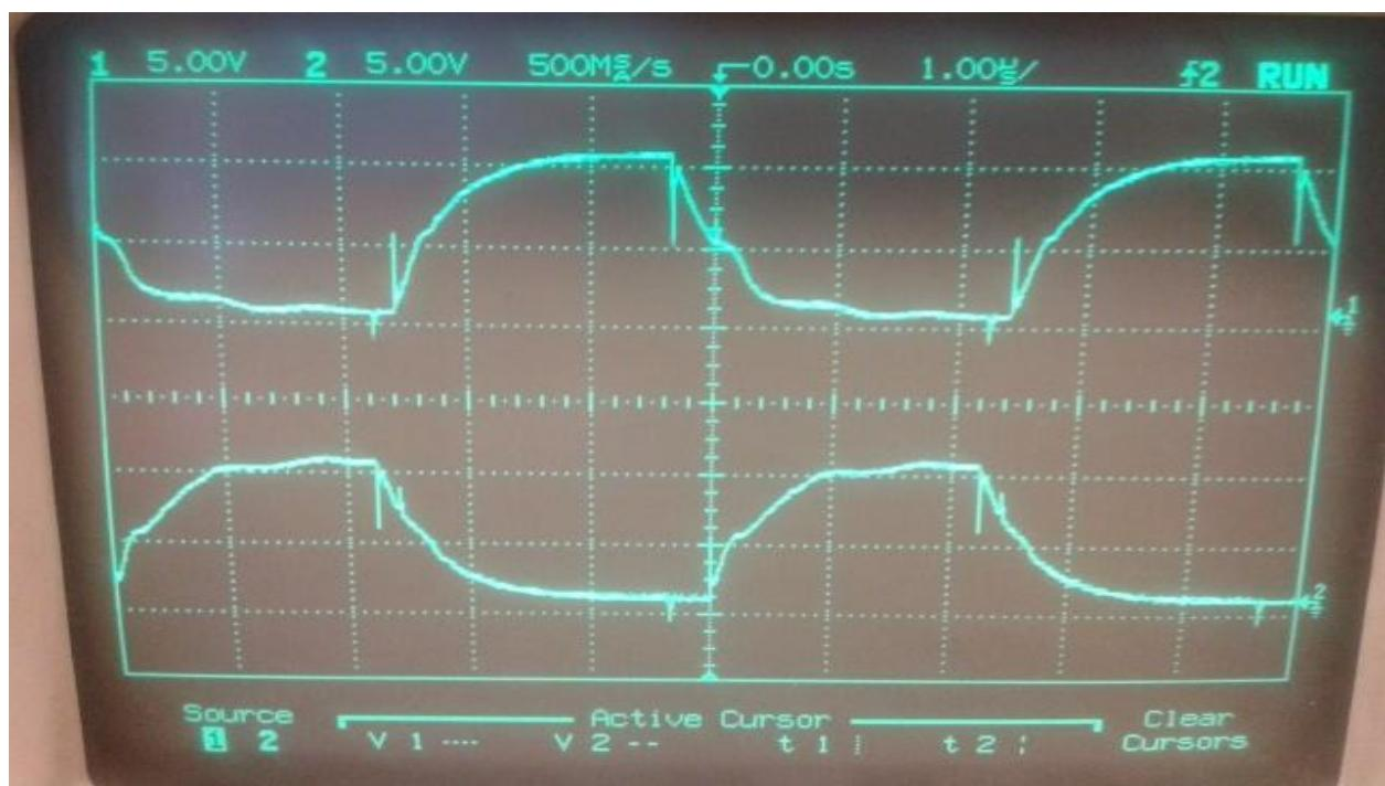
Slika 6.11 Valni oblik upravljačkog napona na upravljačkim elektrodama
