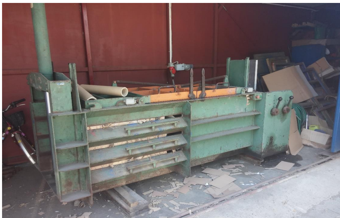
Slika 4.32. Stroj za baliranje otpadnog kartona
