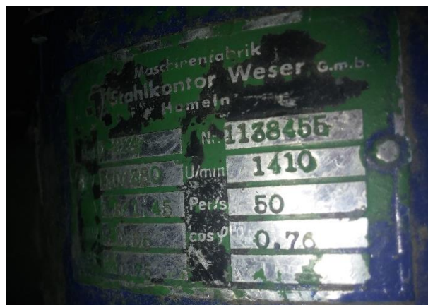
Slika 4.13. Natpisna pločica motora
