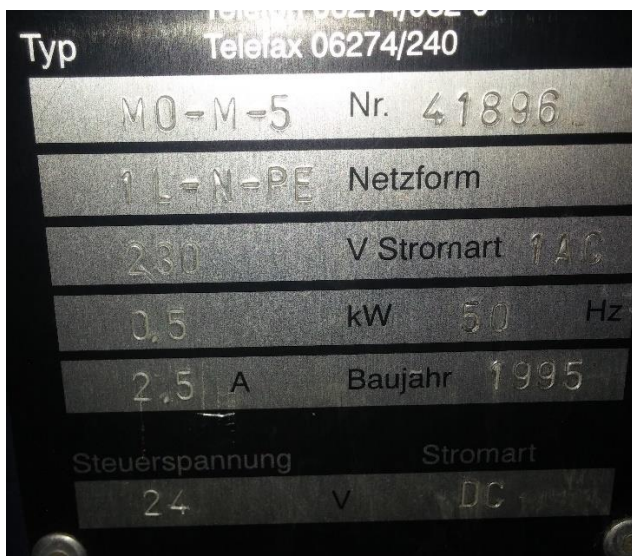
Slika 4.15. Natpisna pločica motora
