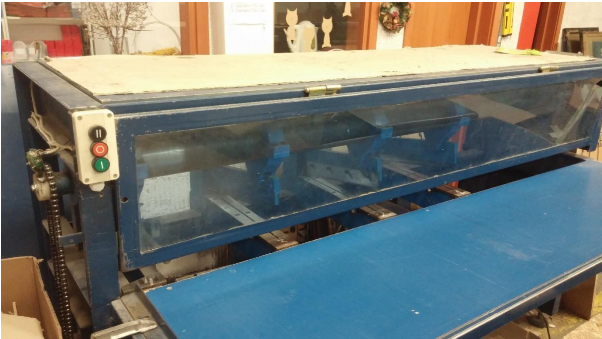
Slika 4.4. Stroj za šlicanje
