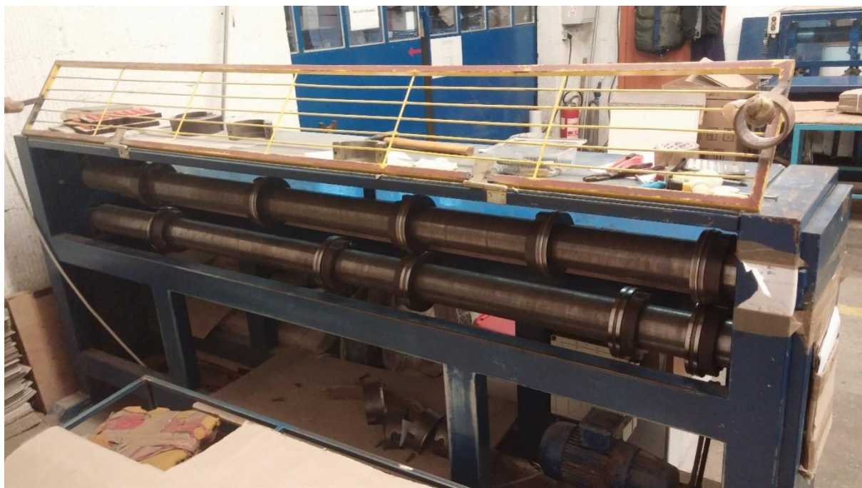
Slika 4.3. Noževi krajšera i motor
