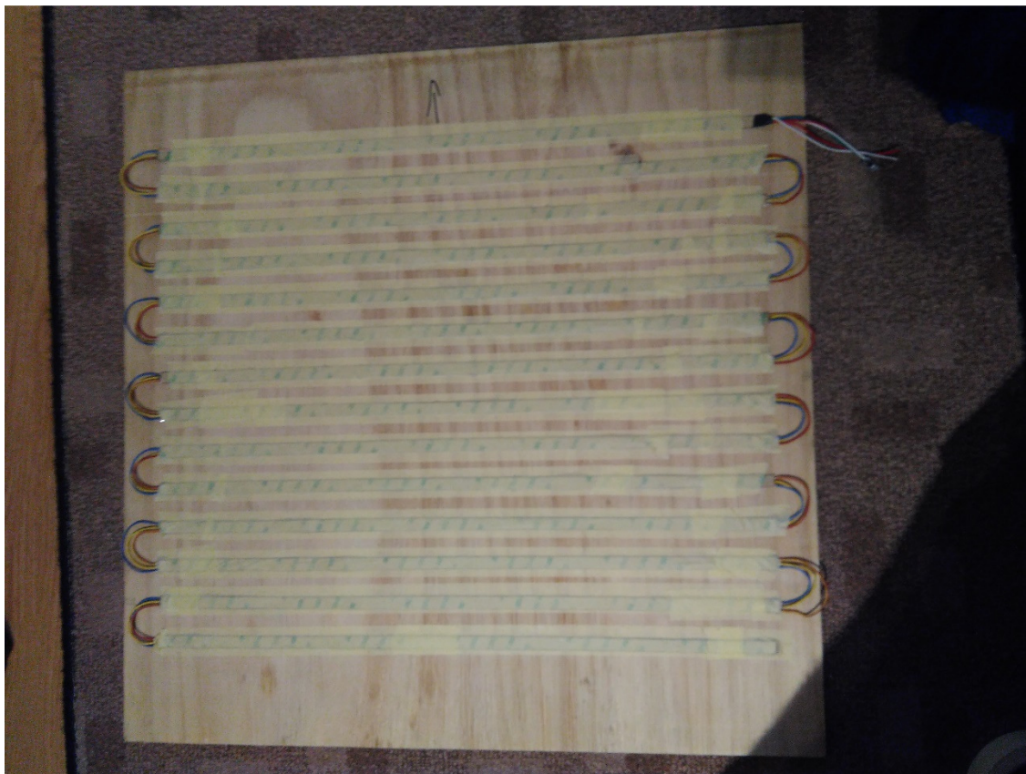
Sl. 3.8 LED-ice pričvrščene ljepljivom trakom
