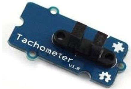
Sl. 2.8. Tachometer speed module
