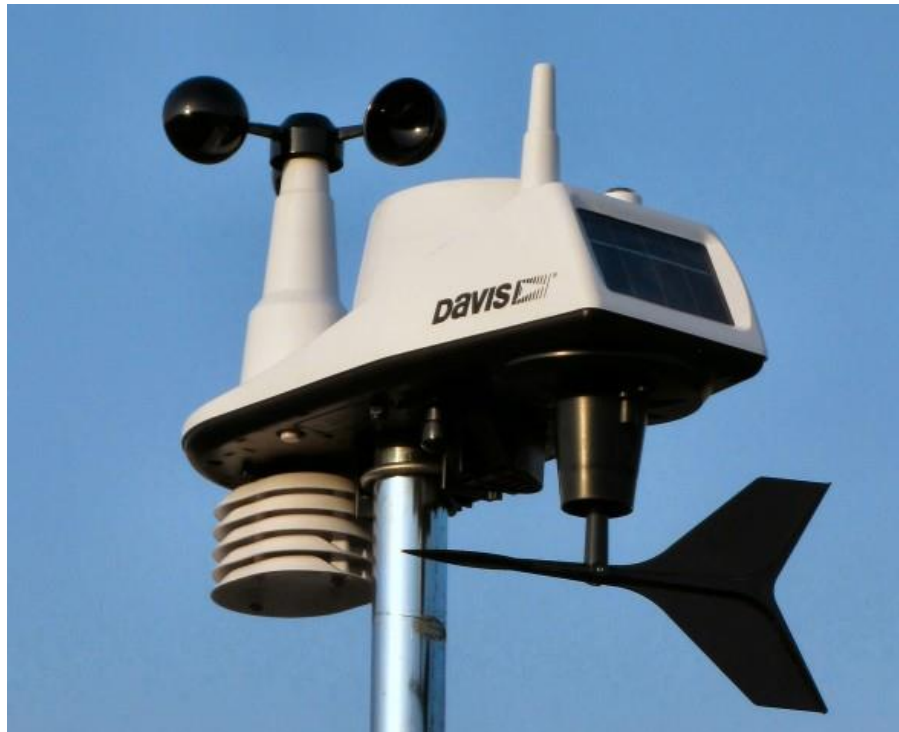
Sl. 1.1 Automatska meteorološka stanica
