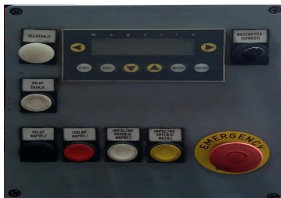
Slika 3.40. Upravljačka ploča stroja VLEKA ŽLEBA 333
