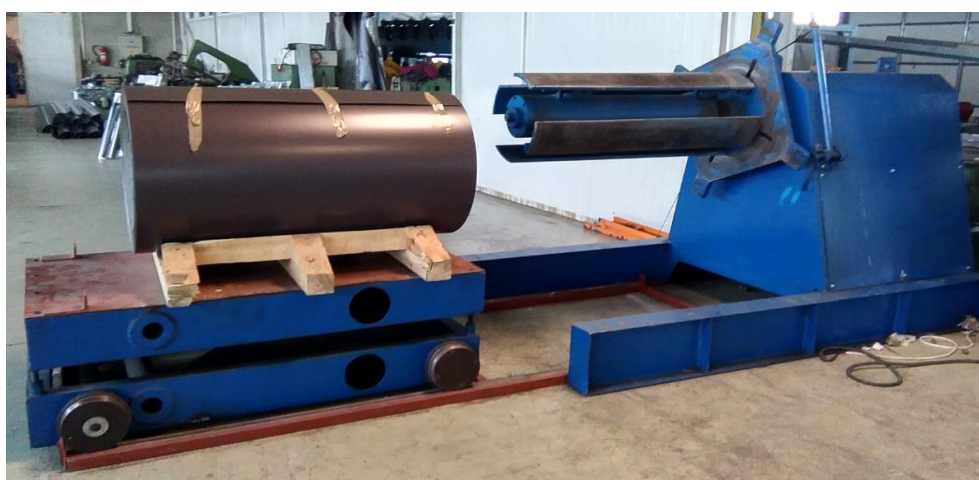
Slika 3.19. Postavljanje role lima na strojna namatalicu
