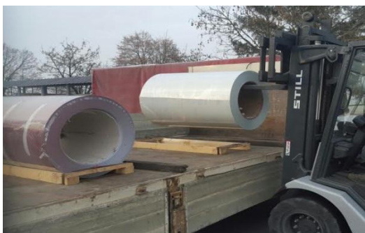
Slika 3.13. Istovar rola lima viličarom
