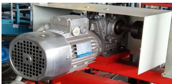
Slika 3.36. Pogonski motor stroja VLEKA ŽLEBA 333
