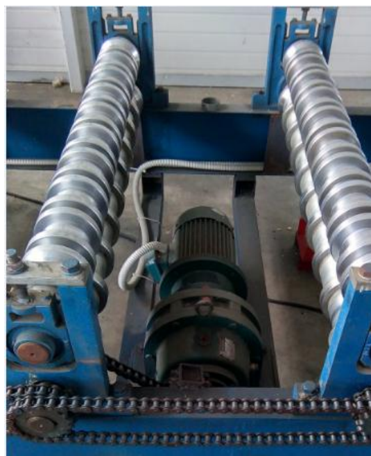
Slika 3.55. Pogonski motor s reduktorom – stroj T-20
