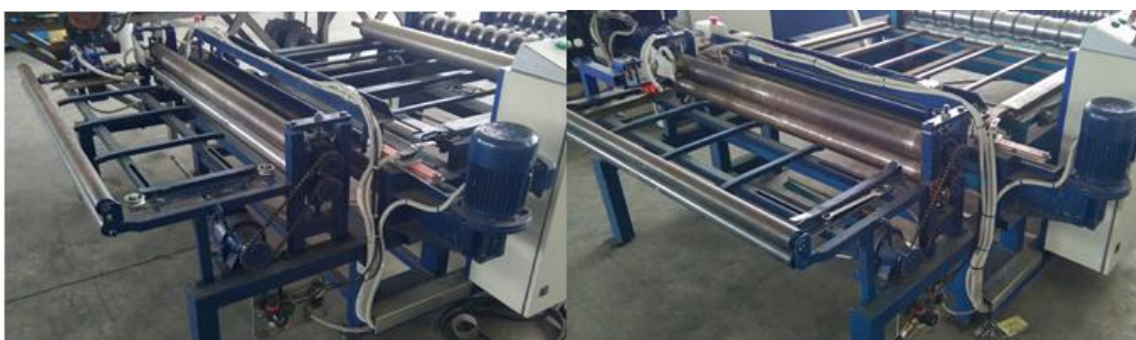
Slika 3.50. Motori za pogon škara i vučnih valjaka stroja V20/77 (lijevo) i T-20 (desno)
