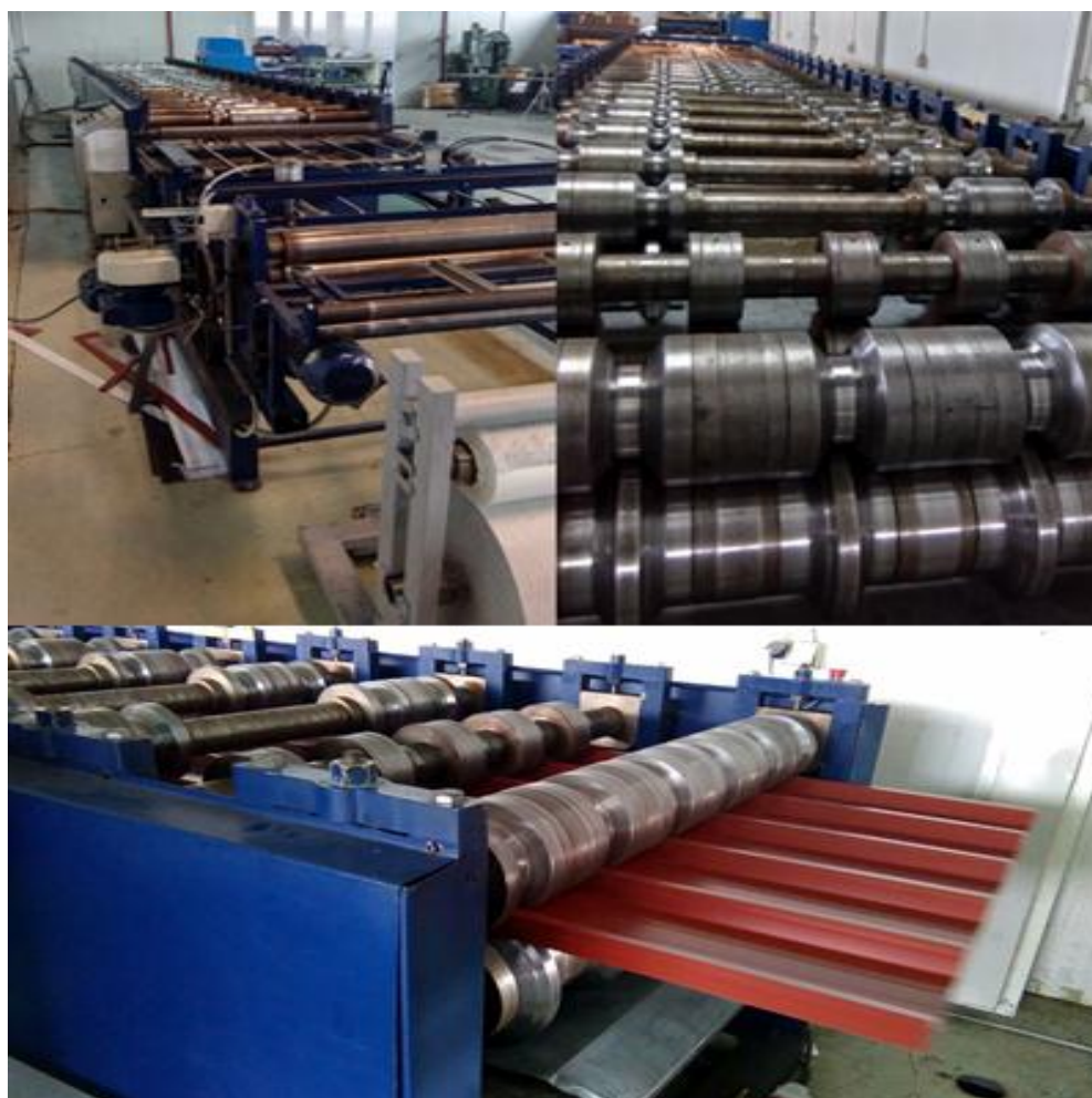
Slika 3.44. Stroj T-35 prikazan iz različitih kutova
