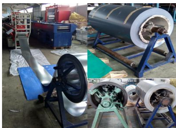
Slika 3.18. Role lima na ručnoj namatalici
