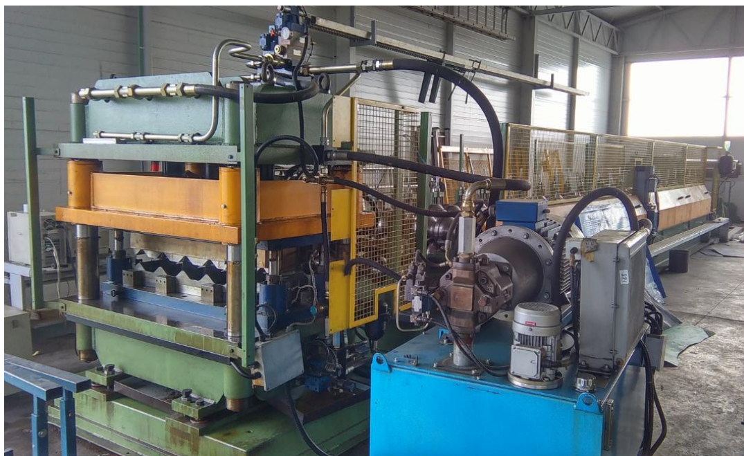
Slika 3.25. Stroj za proizvodnju crijep ploča
