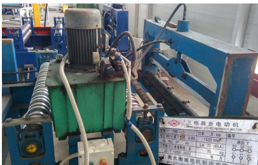
Slika 3.52. Motor za pogon hidrauličnih škara i kadar s natpisnom pločicom motora – stroj T-20
