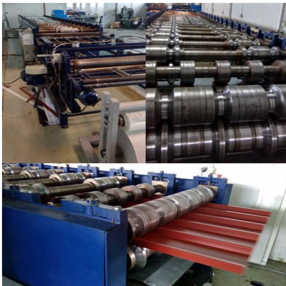
Slika 3.44. Stroj T-35 prikazan iz različitih kutova
