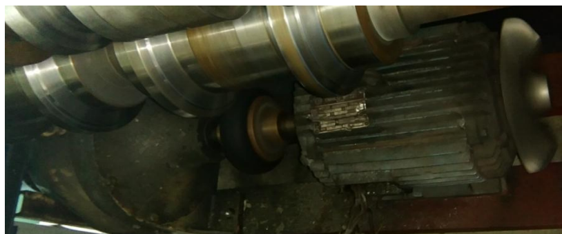
Slika 3.47. Pogonski motor T-35 stroja
