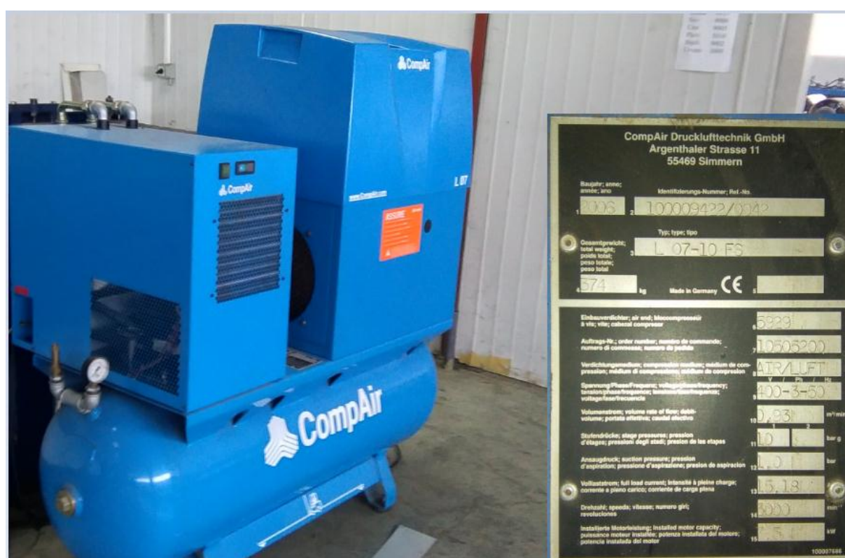
Slika 3.24. Kompresijska stanica i kadar uvećane natpisne pločice
