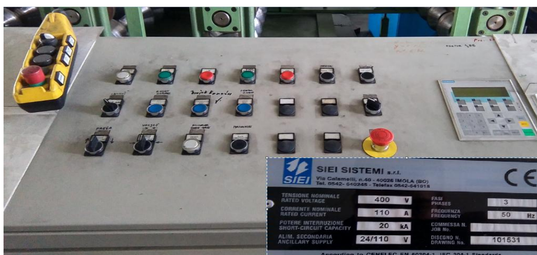
Slika 3.32. Upravljačka ploča s uvećanim kadrom natpisne pločice
