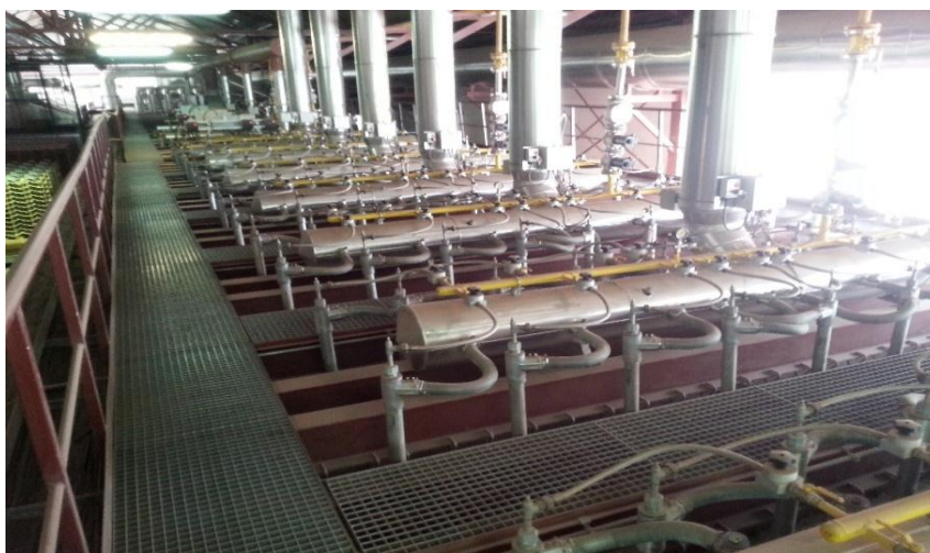
Slika 4.23. Ventili na peći koji doziraju plin
