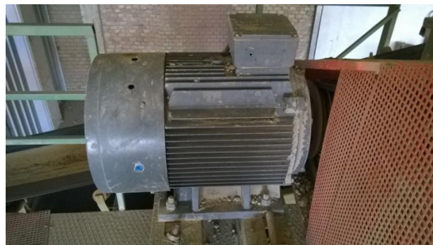
Slika 4.15. Asinkroni motor 2. valjka ispred prese
