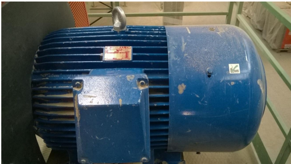
Slika 4.5. Asinkroni motor valjka za grubu preradu
