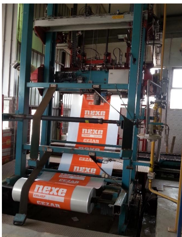
Slika 4.36. Stroj za omatanje palete najlonom
