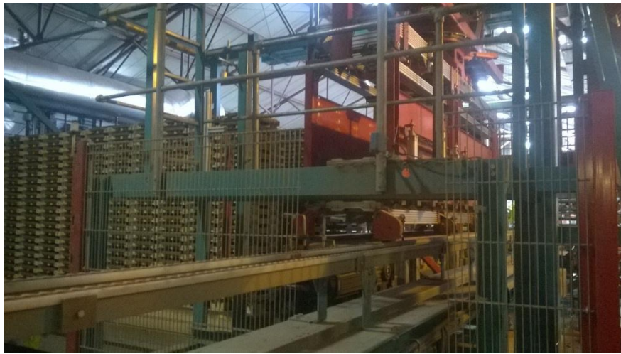
Slika 4.21. Crijep se utovara na vagonne
