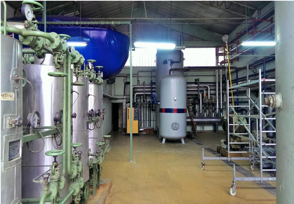
Slika 4.4. Pogon za kružni proces ugljikovog dioksida (CO 2 )
