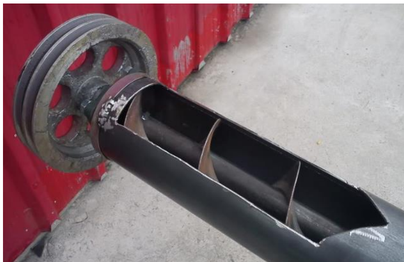
Slika 3.22. Prikaz pužnog transportera
