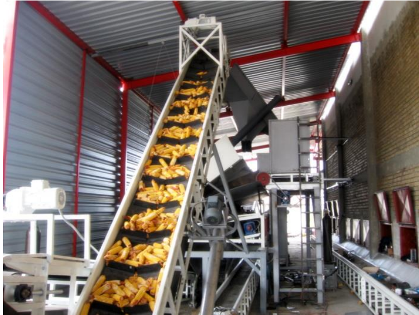
Slika 3.21. Prikaz korištenja transportnih traka u proizvodnji stočne hrane
