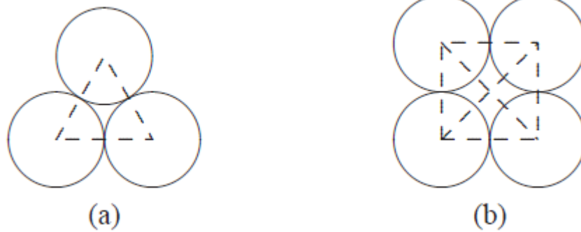
Slika 3.2. Presjek upletenog vodiča, [9].
