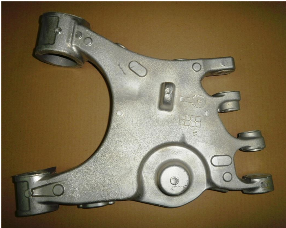
Slika 2.7. Izgled aluminijskog komada nakon uklanjanja pijeska
