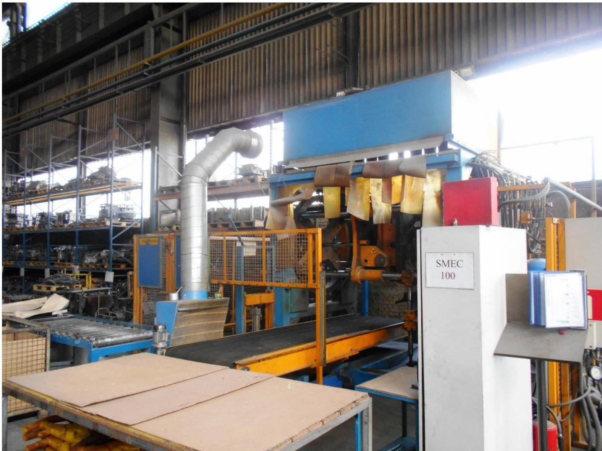
Slika 2.5. Stroj za izradu jezgri
