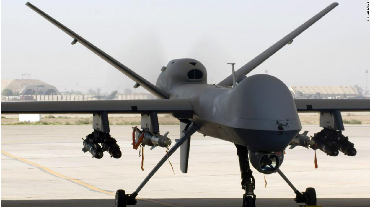
Slika 2.5: Vojni mobilni robot koji leti zrakom te obavlja razne vojne zadatke, od snimanja neprijateljskog teritorija do bombardiranja (izvor: [20]).
