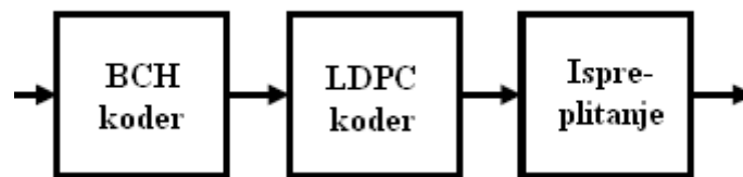
Sl. 2.1. Shema DVB-T2 zaštite od pogrešaka
