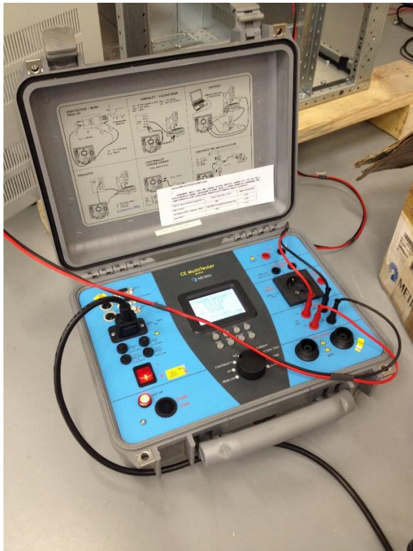
Sl. 3.4. i 3.5. „CE MultiTester MI2094“ proizvođača METREL
