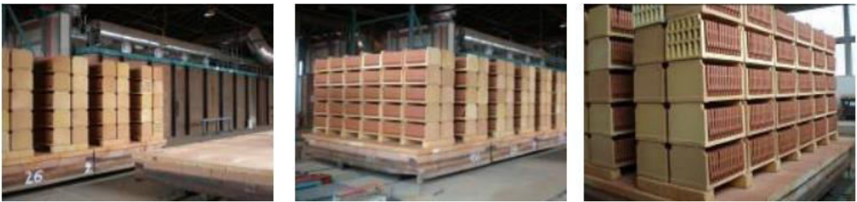
Slika 4.7. Izvoz crijepa iz peći [7, str. 21]
