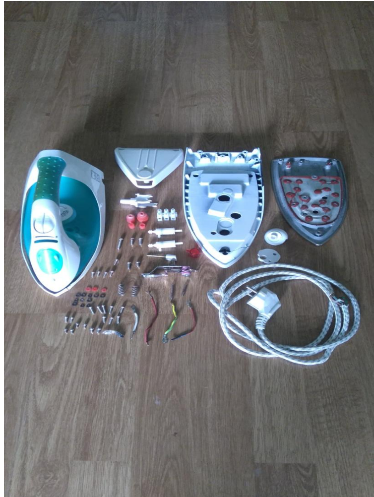
Slika 3.12: Prikaz rastavljenog glačala Simpex
