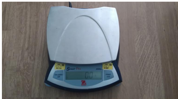
Slika 3.2: Digitalna precizna vaga Ohaus Scout Pro
