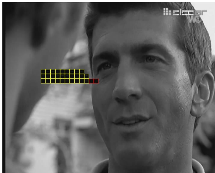
Sl. 4.14. Vertikalno povezivanje makroblokova koji sadrže artefakt gubitka paketa
