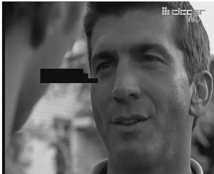
Sl. 4.13. Okvir s neprekrivenim artefaktom gubitka paketa koji se proteže na više redova makroblokova
