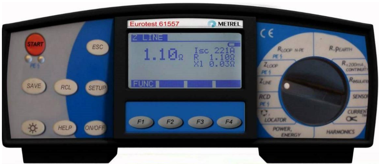
Slika 5.5. Display mjernog instrumenta „METREL“
