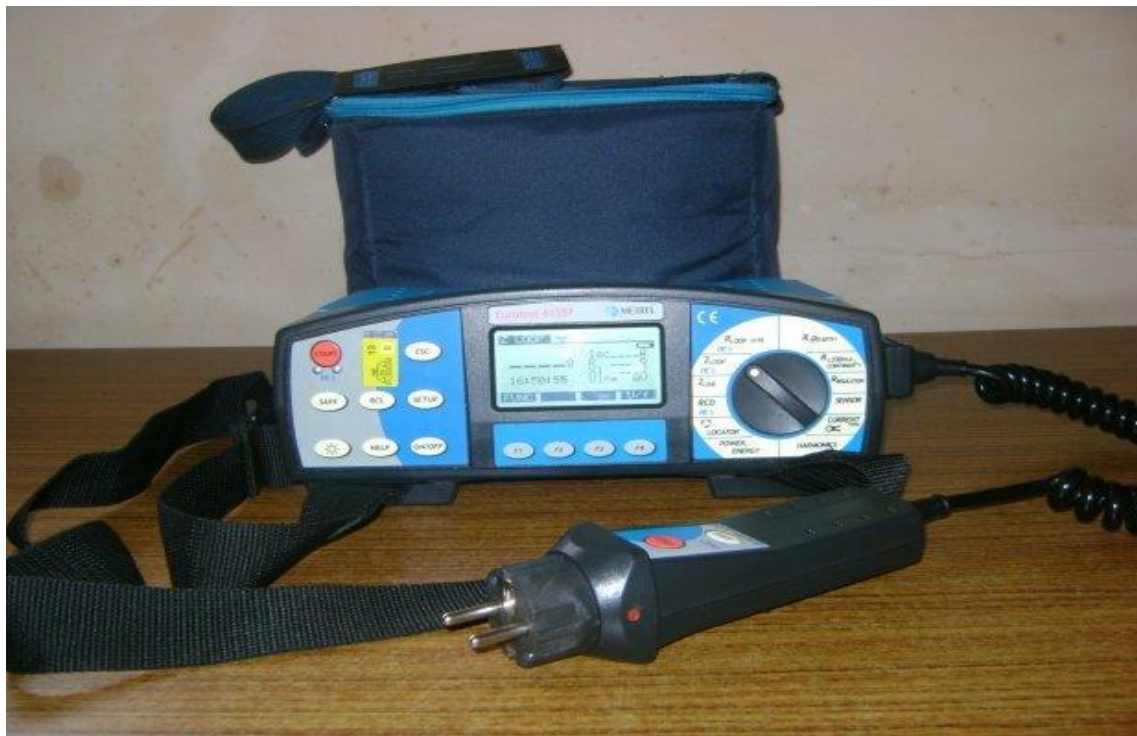
Slika 5.4. Mjerni instrument za mjerenje električnih veličina „METREL“
