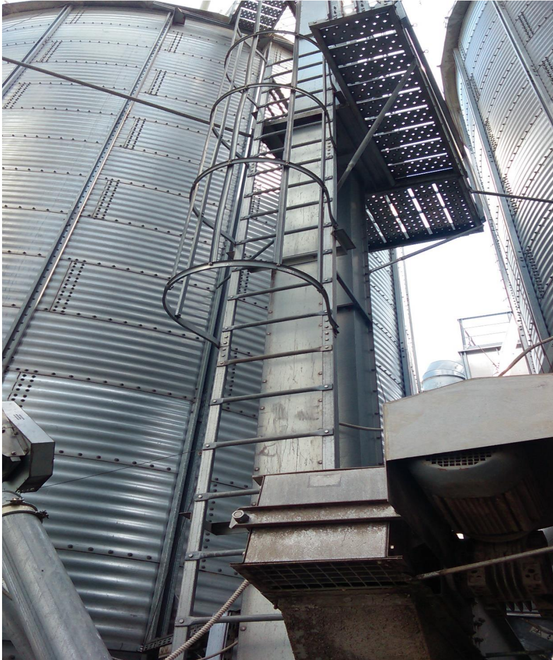
Slika 2.15. Zdjelčasti elevator robe
