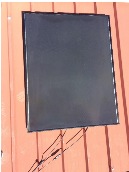
Slika 4.10. Tankoslojni fotonaponski modul pri normalnoj ozračenosti u trenutku obavljanja mjerenja.
