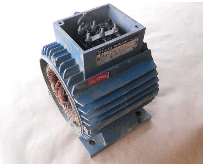
Slika 4.1. Stator i priključna kutija trofaznog asinkronog kaveznog elektromotora
