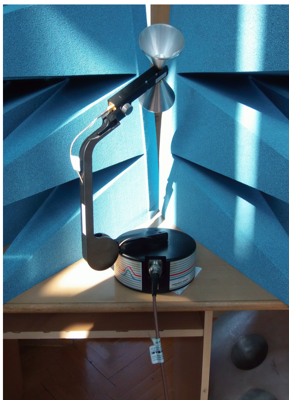
Sl. 4.3. Odašiljačka antena okrenuta na 0° za Ex komponentu polja.
