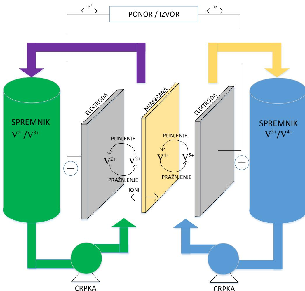
**Slika 3.8** Shematski prikaz vanadiumredoks protočne baterije [3]
