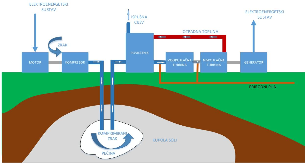
**Slika 3.4** Sustav pohrane energije komprimiranim zrakom [3]
