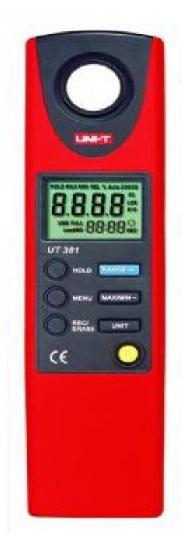
Slika 3.2.1. Digitalni luxmetar UNI-T UT 381 [21]
