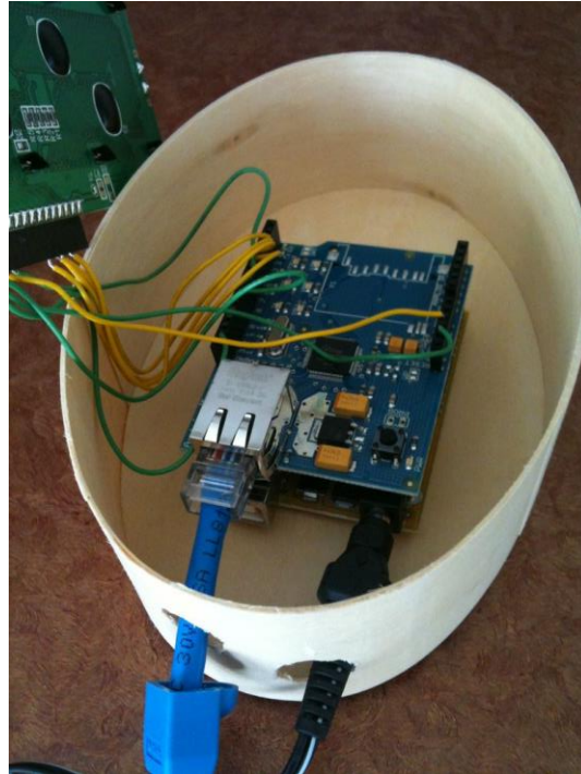
Sl. 4.2. Arduino Uno sa mrežnim modulom
