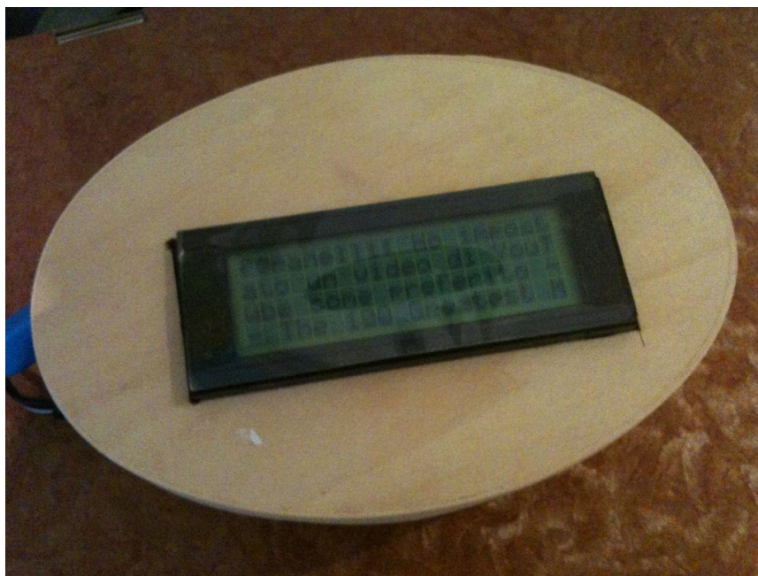
Sl. 4.1. Prikazivač objava sa Twitter-a baziran na razvojnoj platformi Arduino
