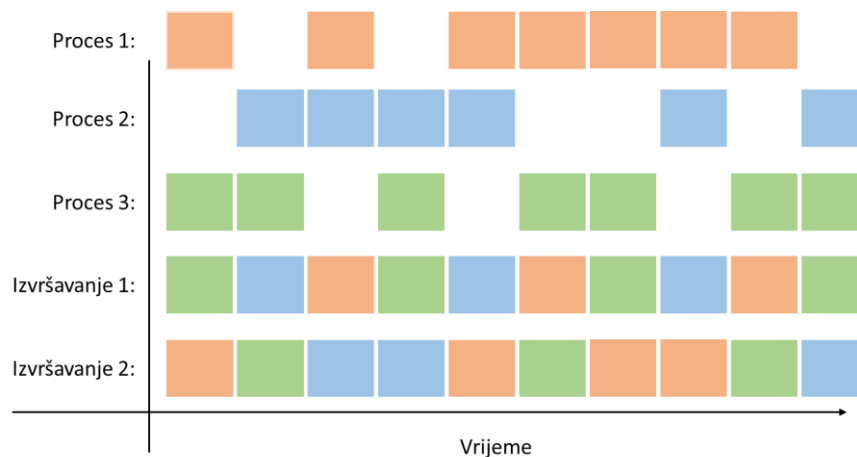
Sl. 2.13: Podjela vremena izvođenja više procesa na više procesora
