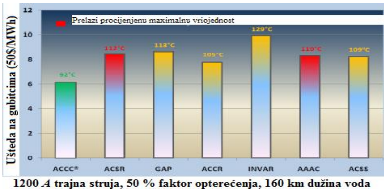
Slika 2.7. Usporedba gubitaka na vodovima (i radnih temperaturama) različitih materijala uz faktor opterećenja 50% i dužina voda 160 km. (Izvor: www.ctcglobal.com ; Preuzeto: travanj 2016.god)
