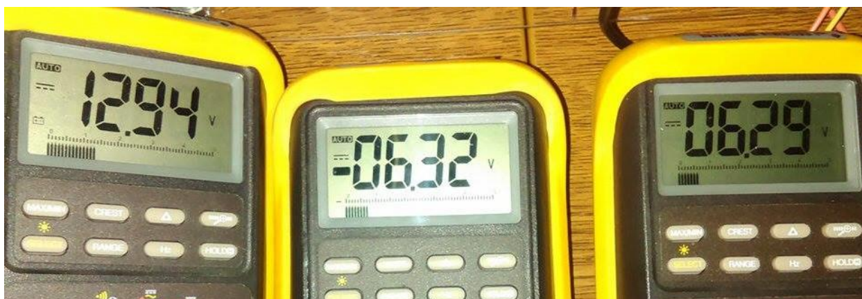
Slika 4.7. Napon napajanja i srednje vrijednosti napona U_{GS}(0) na P kanalnom MOSFET-u (negativno) i N kanalnom MOSFET-u (pozitivno).
