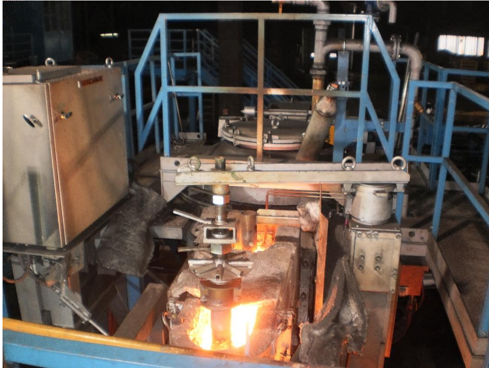
Slika 6.3. Grafitna štanga-proces lijevanja u tijeku ( fotografirano 5.2.2016 )
