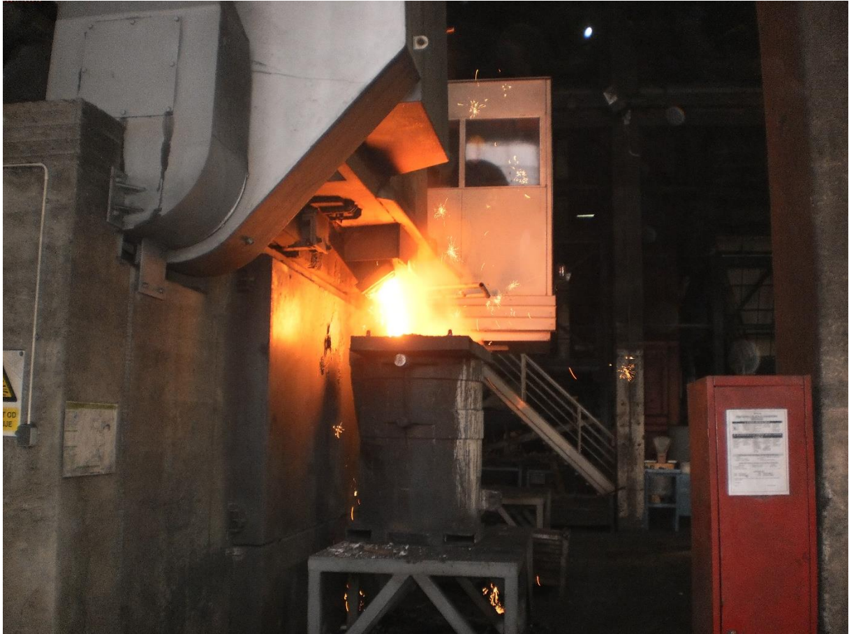
Slika 4.2. Lijevanje taline iz elektropeći u lonac za transport ( fotografirano 5.2.2016 )
