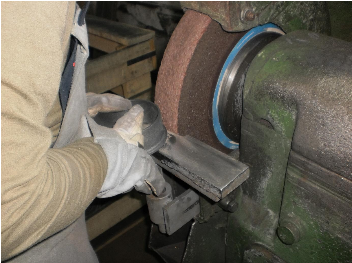
Slika 7.1. Brušenje odljevka ( fotografirano 5.2.2016 )
