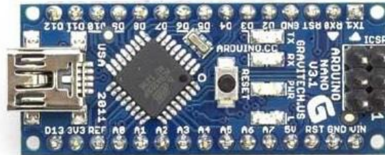
Slika 2.4. Arduino Nano verzija 3.0 1
