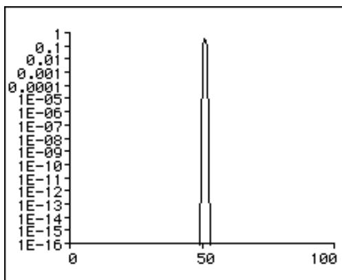
**Slika 3.1** Oblik mjerenog signala čija će se frekvencija preklapati sa bin frekvencijom ; Izvor:
