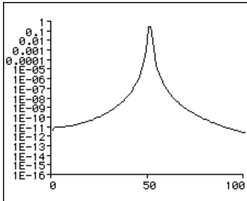
**Slika 3.2** Oblik mjerenog signala čija se frekvencija neće preklapati sa bin frekvencijom; Izvor:
