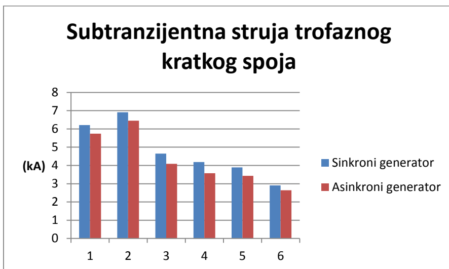
Slika 4.22: Usporedba subtranzijentne struje sinkronog i asinkronog generatora
