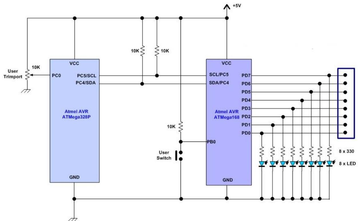
*Slika 5.1. Shema I<sup>2</sup>C povezanosti mikrokontrolera ATMega328P (master) i ATMega168 (slave) bez dodatnog napajanja LED dioda [10]*
