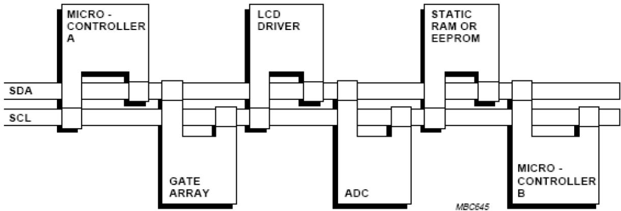
*Slika 3.1. Primjer spajanja komponenata na I<sup>2</sup>C sabirnicu (logička shema).[1]*
