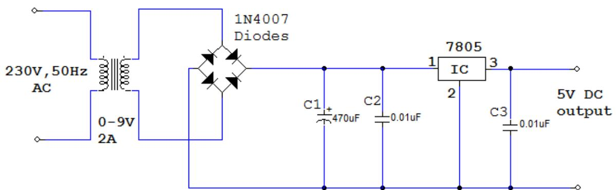
**Slika 3.11. Izvedba istosmjernog napajanja napona 5V sa LM7805 [6]**
