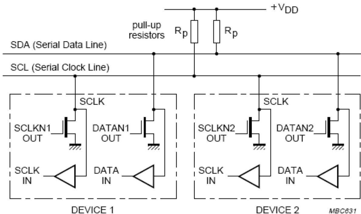
*Slika 3.2. Primjer spajanja komponenata na I<sup>2</sup>C sabirnicu (električna shema) [2]*
