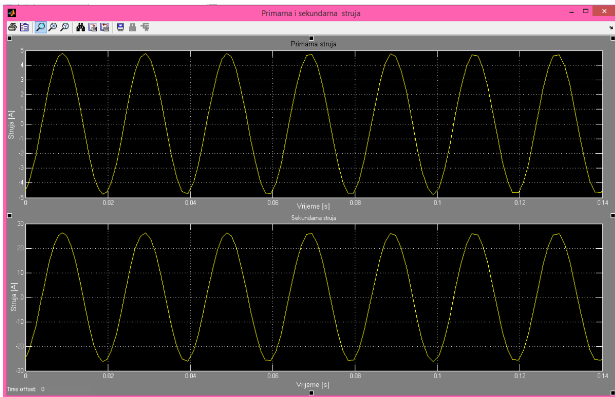
Slika 4.4. Primarna i sekundarna struja za RC trošilo
