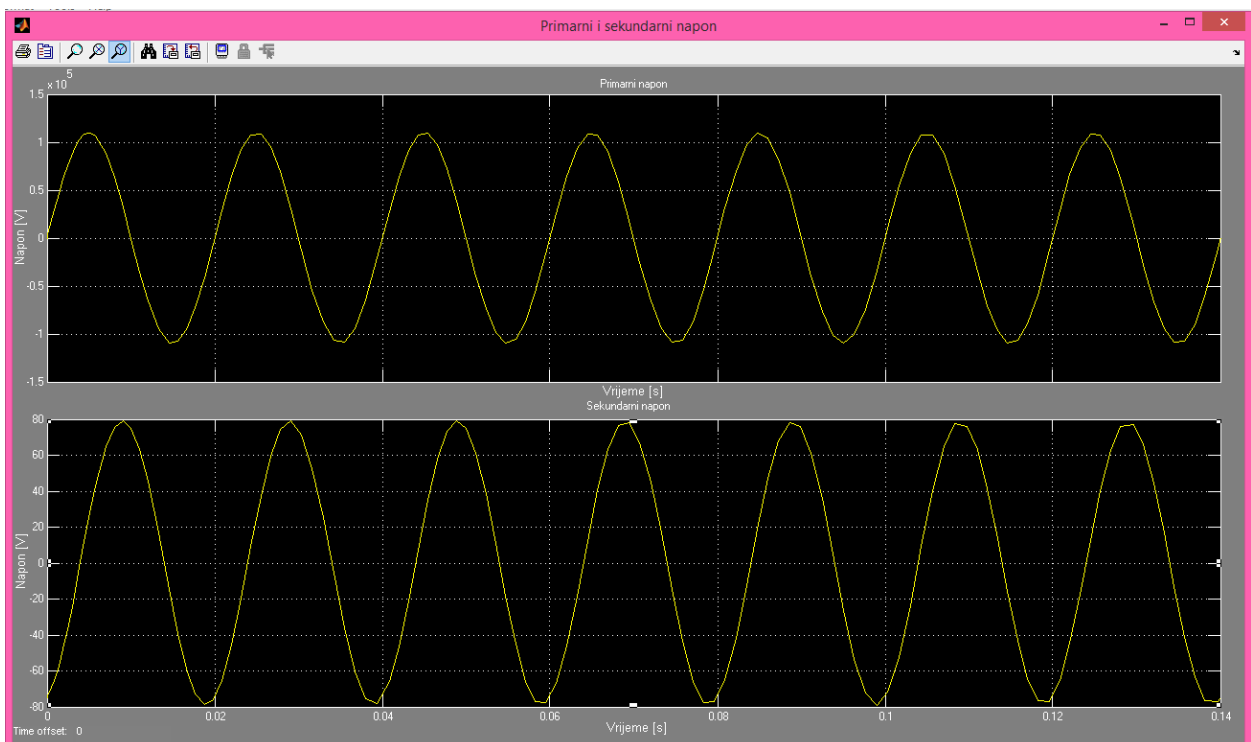
Slika 4.7. Primarni i sekundarni napon za R trošilo
