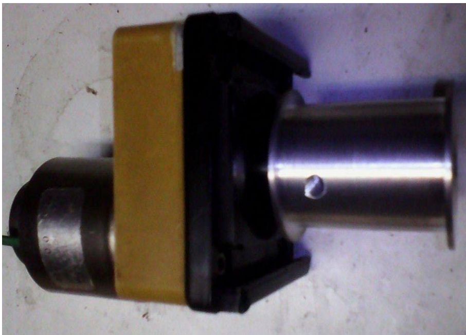
Sl. 3.2. Istosmjerni motor s aluminijskim valjkom.
