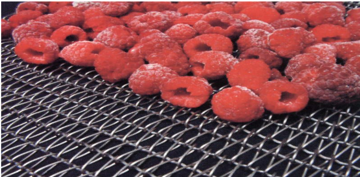
Sl. 2.5. Traka od pletene žice korištena u prehrambenoj industriji [5].
