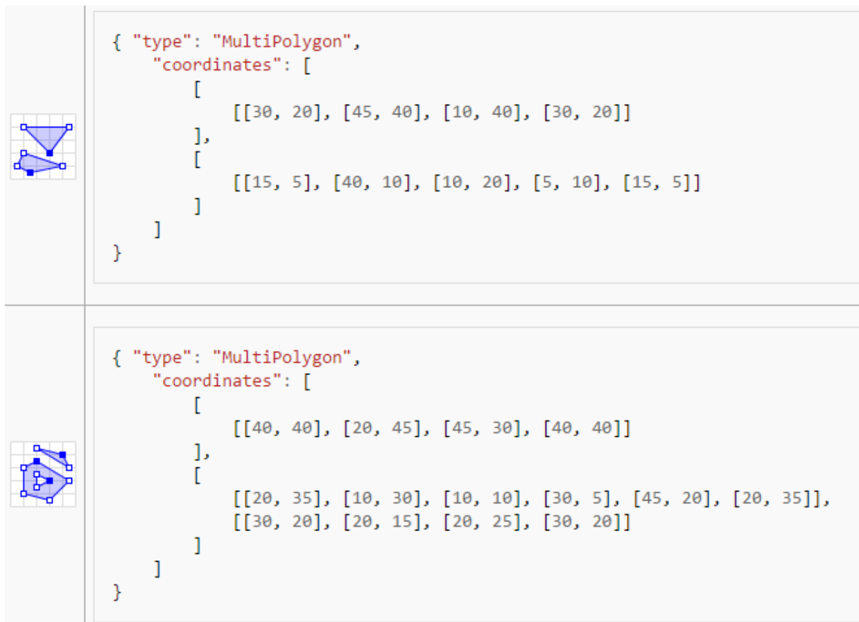
Slika 3.8. Primjer GeoJSON objekta za tip „MultiPolygon“ [Izvor: https://en.wikipedia.org/wiki/GeoJSON ]
