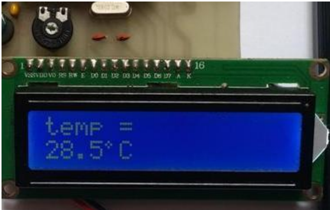
Slika 3.6: LCD zaslon 16x2
