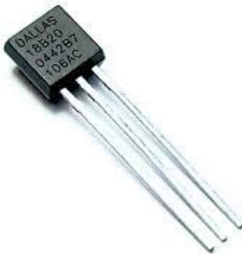
Slika 3.11: Digitalni temperaturni senzor DS18B20
