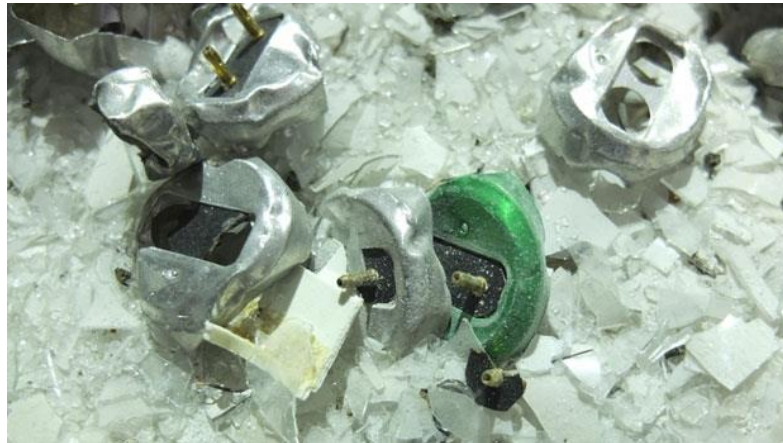
Slika 4.5. Zdrobljeni materijal u bačvi dobiven „crusher“ uređajem [22]
