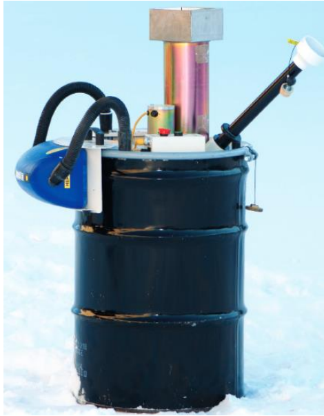
Slika 4.4. „Crusher“ uređaj za recikliranje fluorescentnih cijevi
