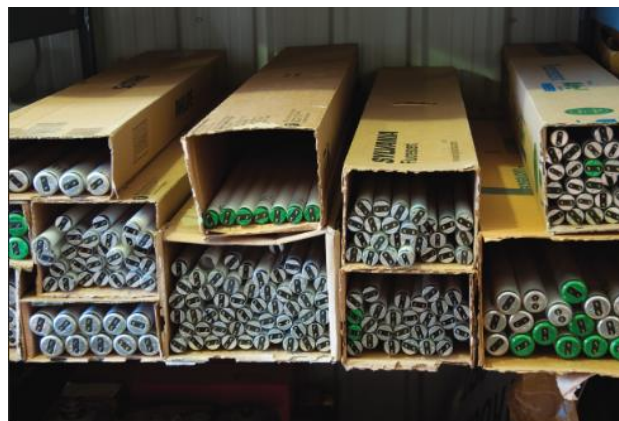
Slika 4.2. Preporučljivo odlaganje istrošenih rasvjetnih tijela (fluo cijevi)
