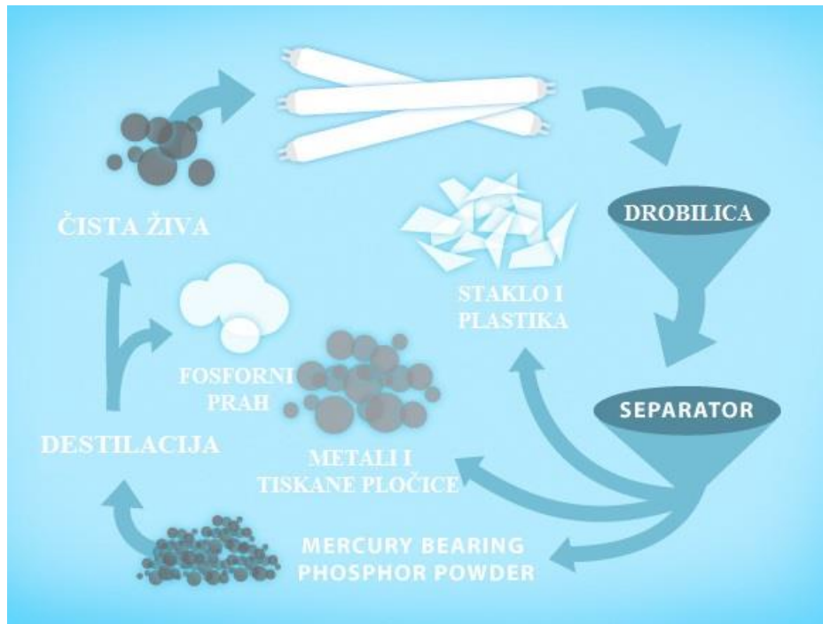
Slika 4.3. Jednostavni prikaz procesa recikliranja fluorescentnih žarulja
