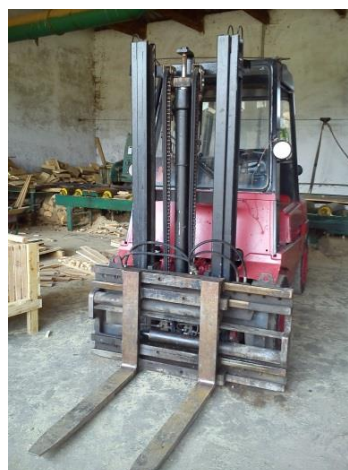
Slika 4.4. Viličari za transport drvenih trupaca
