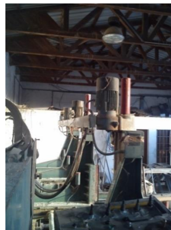
Sl. 4.7. Elektromotori za prilagodbu položaja
