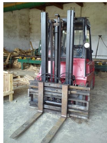
Slika 4.4. Viličari za transport drvenih trupaca
