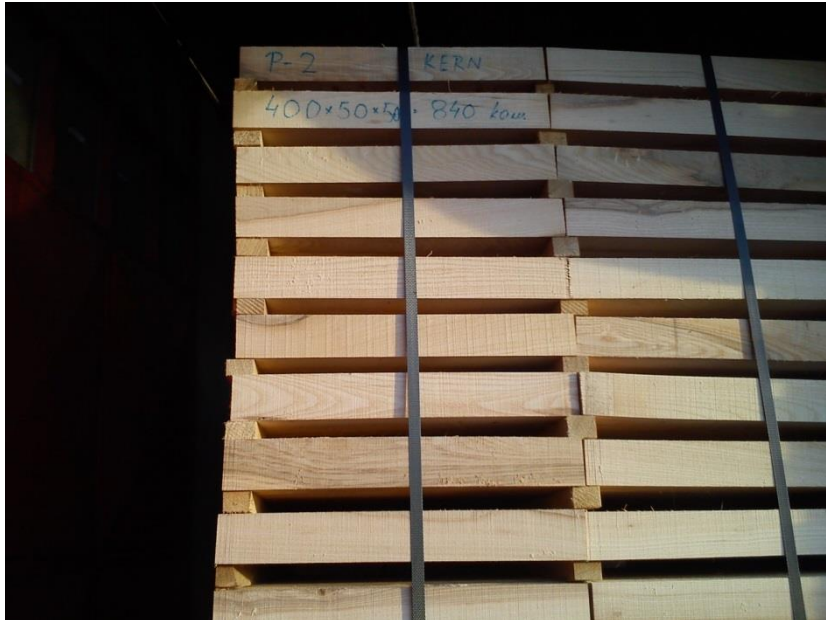
Slika 5.7. Gotova paleta izrezanih elemenata
