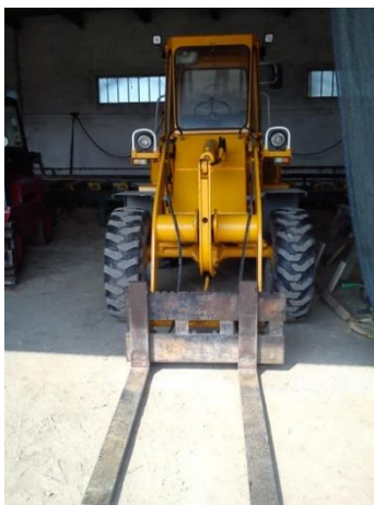
Slika 4.4. Viličari za transport drvenih trupaca
