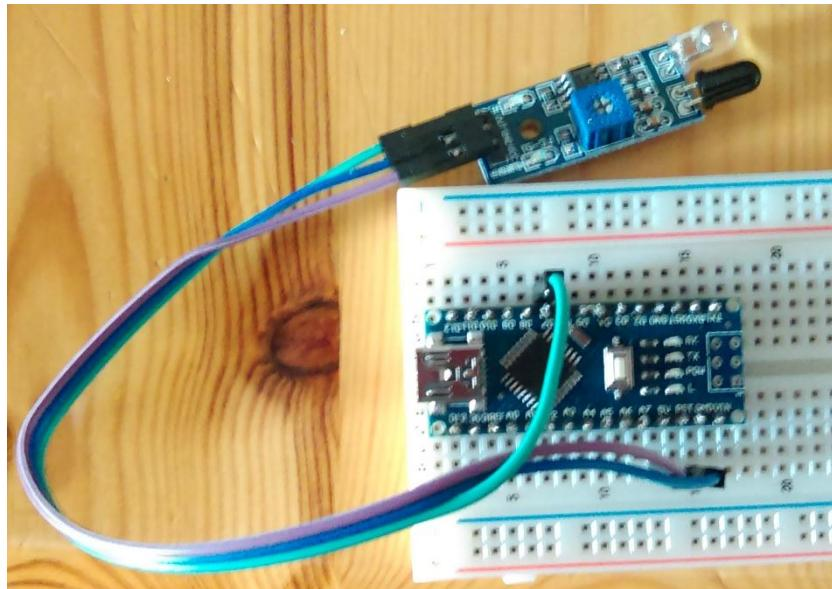
*Slika 4.5. Spoj IR senzora i Arduina*
