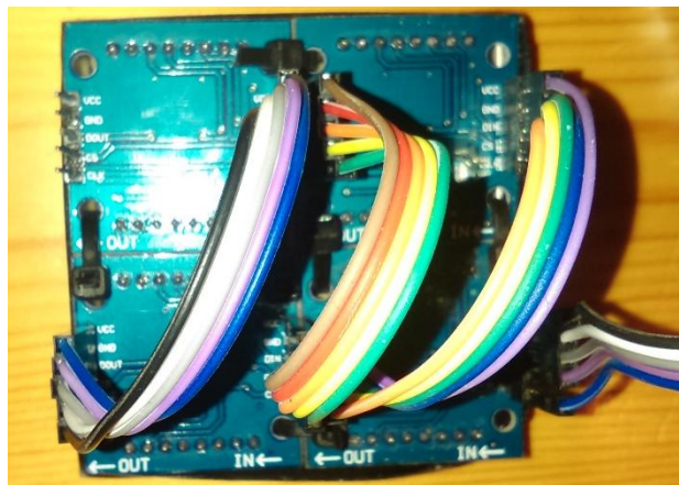
Slika 4.9. Međusobno povezivanje više modula
