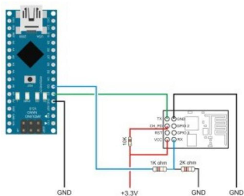
Slika 4.2. Shematski prikaz povezivanja Arduina i ESP8266
