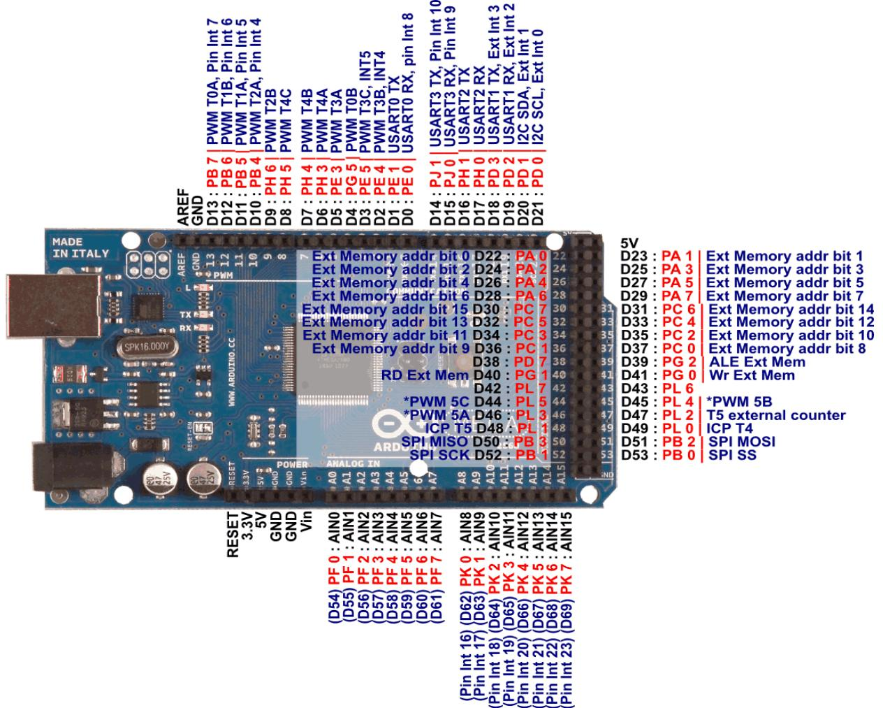
Slika 3.2. Prikaz pinova kod Arduino Mega sustava
