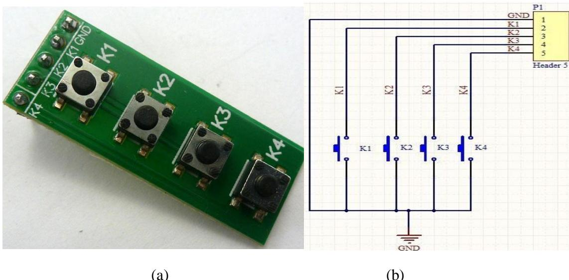
Slika 3.4. Polje tipkala (a) i shema razvojne pločice (b)
