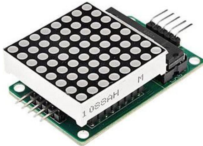
Slika 3.6. LED matrični pokazivač.
