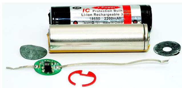
Sl. 3.25. prikaz konstrukcije 18650 baterije. [Izvor: http://www.lygte-info.dk/info/battery%20protection%20UK.html ]
