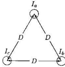
Slika 2.9. Trofazni vod sa simetričnim razmakom [1]
