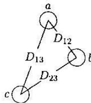
Slika 2.10. Trofazni vod s asimetričnim razmakom iz [1]
