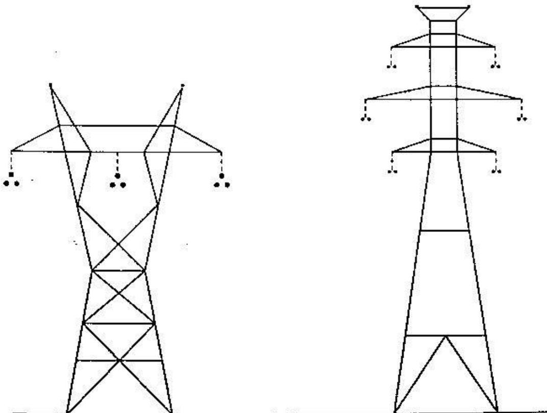
Slika 2.1 Tipična rešetkasta struktura za 345-kV dalekovode [1]
