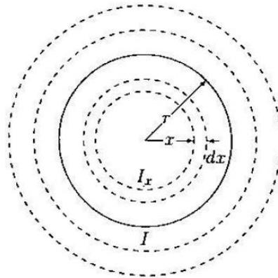
Slika 2.6. Prikaz magnetskih silnica oko dugog okruglog vodiča [1]
