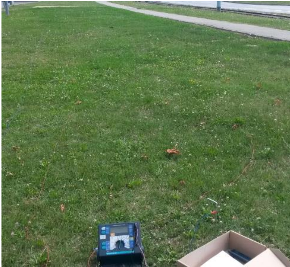
Slika 4.5. Mjerenje otpornosti tla uz tramvajsku prugu
