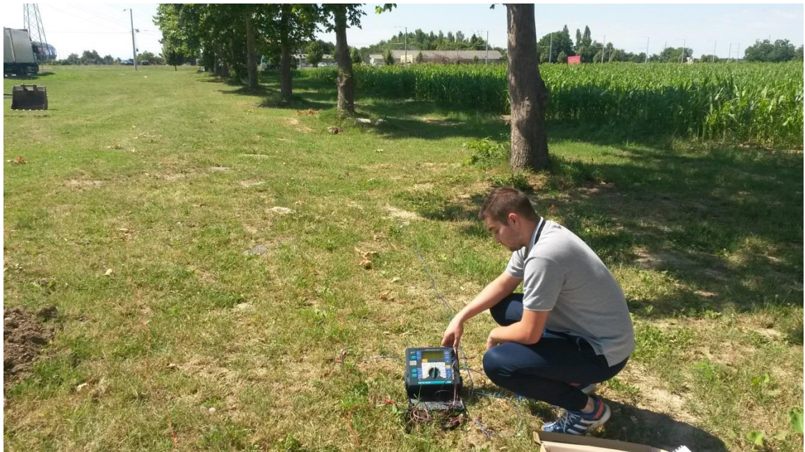
Slika 4.4. Mjerenje otpornosti tla na mekanoj zemlji
