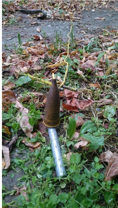
Slika 4.4. Spoj vodiča s mjernom sondom
