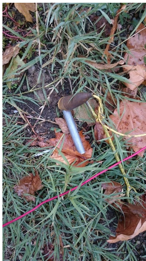
Slika 4.6. Spoj vodiča s mjernom sondom
