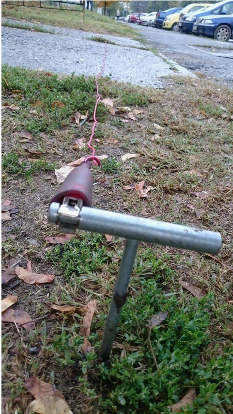
Slika 4.3. Spoj vodiča s mjernom sondom izvučenom iz zemlje
