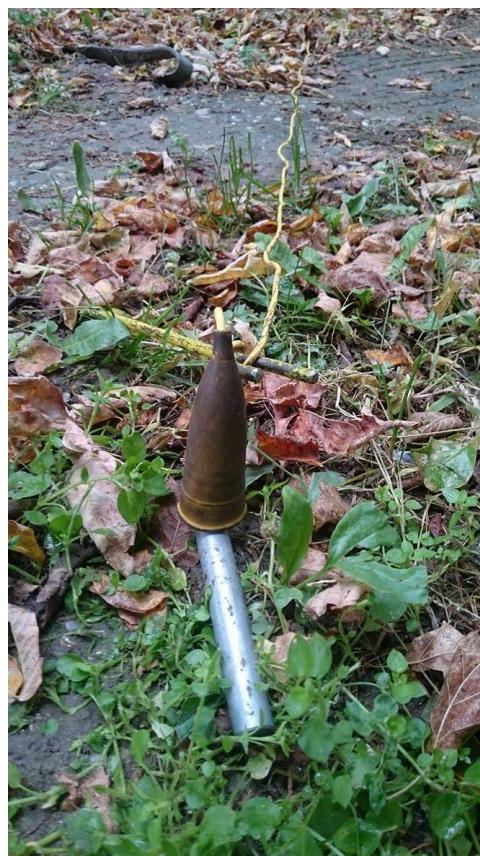
Slika 4.4. Spoj vodiča s mjernom sondom
