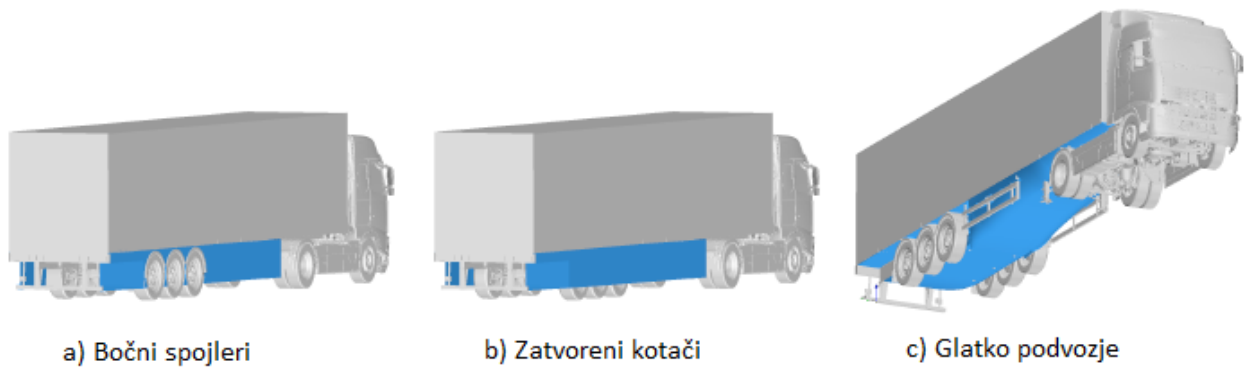
Slika 5.13. Tretiranje podvozja. Izvor [18].
