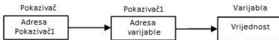
Slika 3.2.1. Pokazivač na pokazivač
