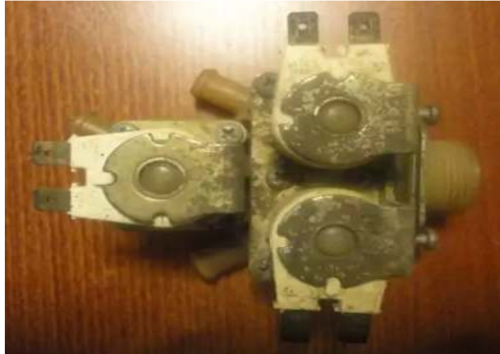
Slika 3.21. Vanjski izgled elektroventila perilice rublja.
