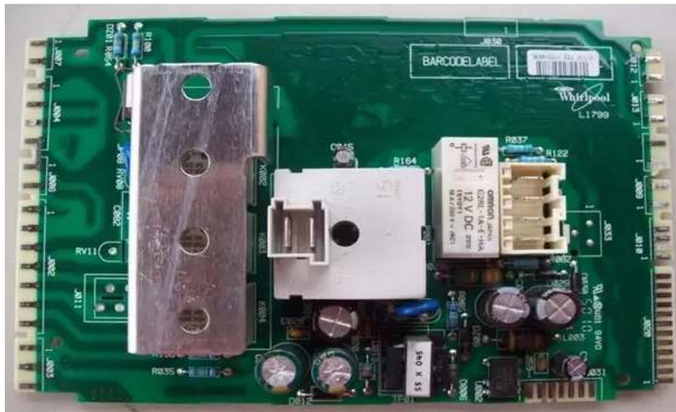
Slika 4.2. Elektronički dijelovi perilice rublja.
