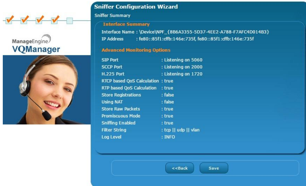
Slika 5.1.5. Postavke naprednih mogućnosti praćenja sniffera
