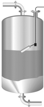
Sl. 3.3. Detektor razine s plovkom
