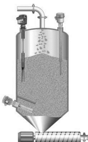
Sl. 3.27. Vibracijska mjerila razine
