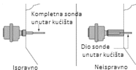
Sl.3.51. Način montaže osjetila kod medija s malom dielektričnom konstantom
