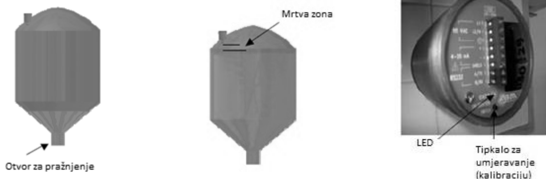
Sl.3.46. Unutarnje umjeravanje spremnika
