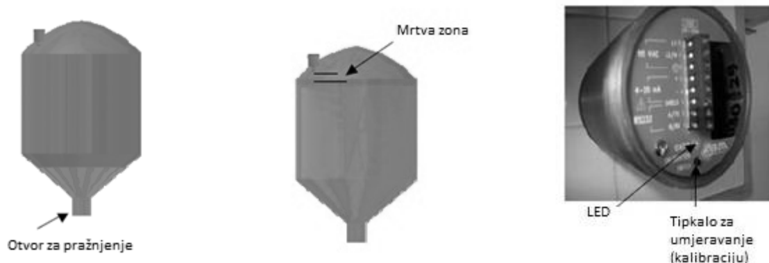
Sl.3.46. Unutarnje umjeravanje spremnika
