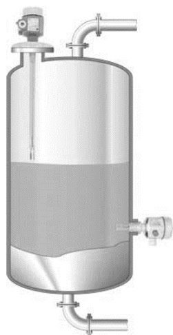
Sl. 3.26. Vibracijski detektori razine
