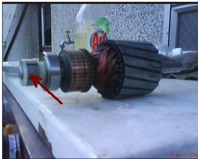
Sl. 3.1. Tahogenerator priključen na osovinu[8].
