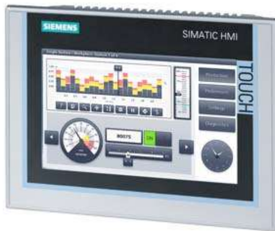
Slika 3.4. Simatic HMI TP700 Confort
