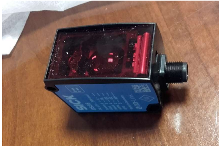
Slika 3.7. Senzor SICK WT12-2B523
