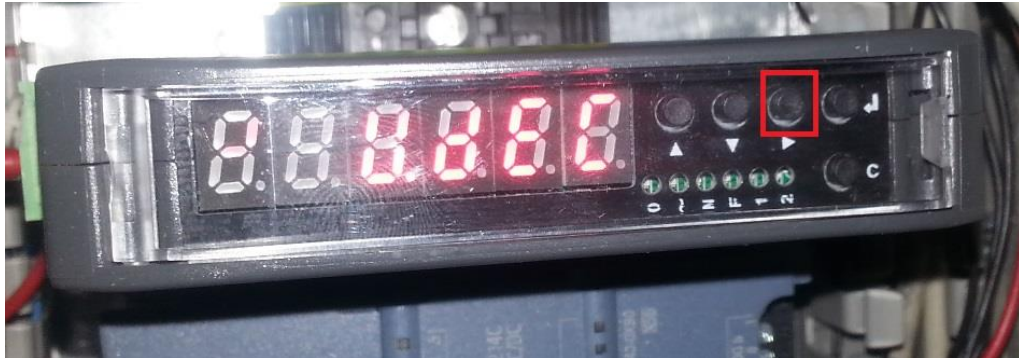
Slika 4.11. Prikaz upravljačkih tipki i zaslona slave uređaja
