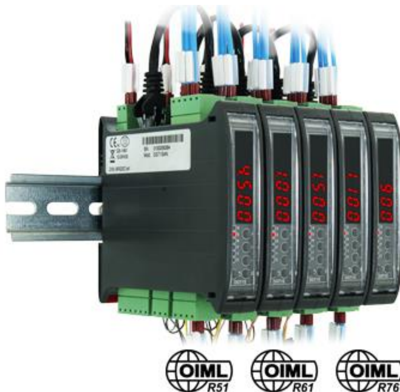
Slika 3.11. DGTIS analogni digitalni pretvornik sile [14]
